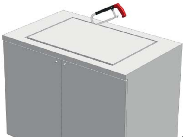
NYÍLÁS KIVÁGÁSA A FŐZŐLAP TELEPÍTÉSÉHEZ
